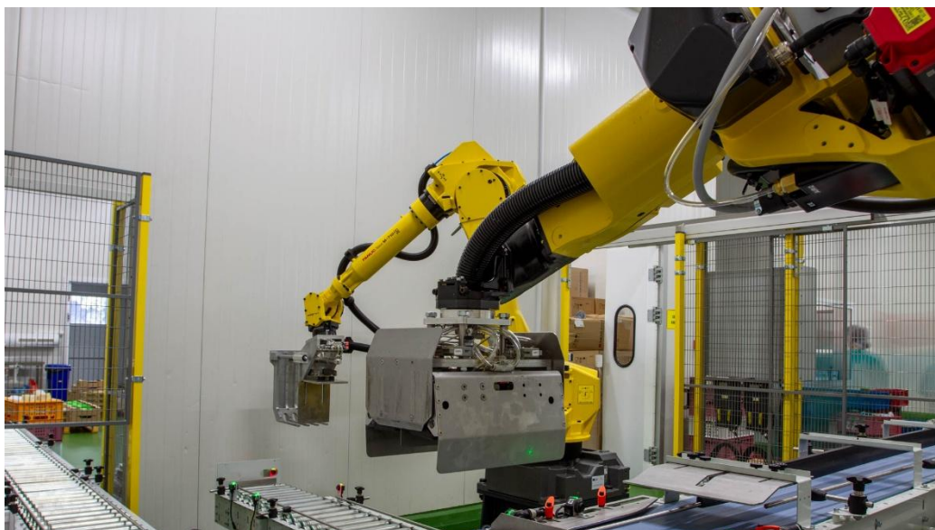
Пакетиране и палетизиране на хранителни продукти с два робота
