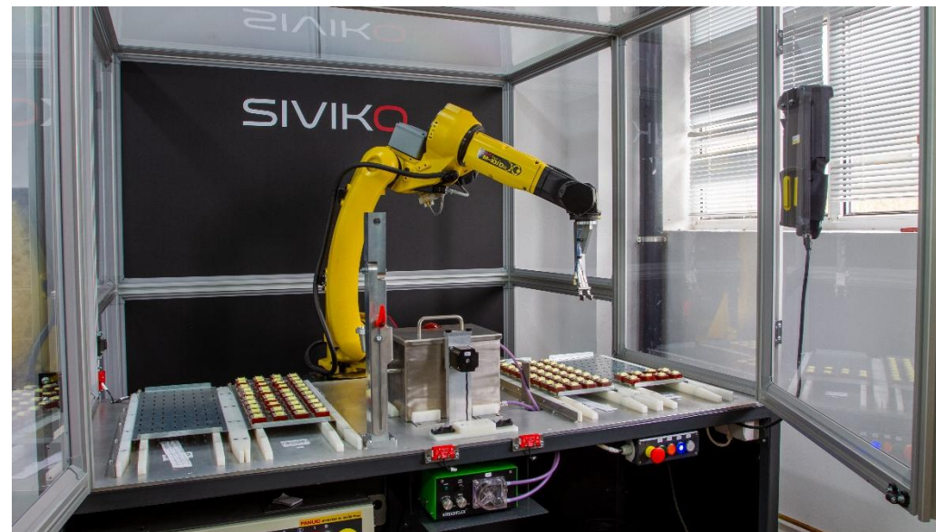
Ролково боядисване на индуктивни компоненти от робот
